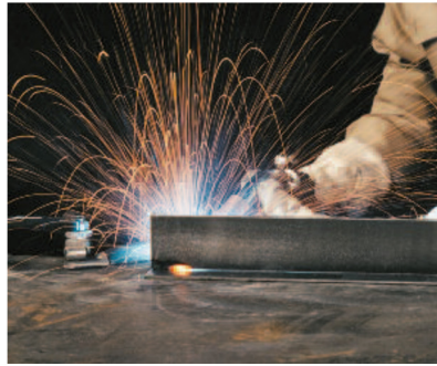
Transferencia de corto circuito CV convencional usando CO 2 y alambre sólido de .045 in.
