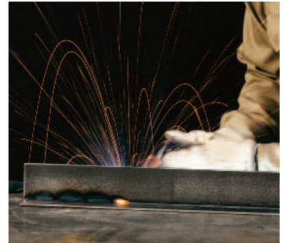
STT® usando CO 2 y alambre sólido .045 in. Reducidas salpicaduras y emanaciones.
