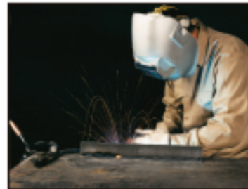
STT® usando CO 2 y alambre sólido de .045 in. Reducidas salpicaduras y emanaciones.
