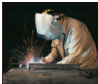
Transferencia de corto circuito CV convencional usando CO 2 y alambre sólido de .045 in.
