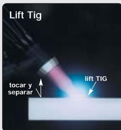
El Invertec V70-S está equipado con "Hot Start" regulable, ofreciendo una corriente inicial elevada para ayudar a un fácil cebado del electrodo.
